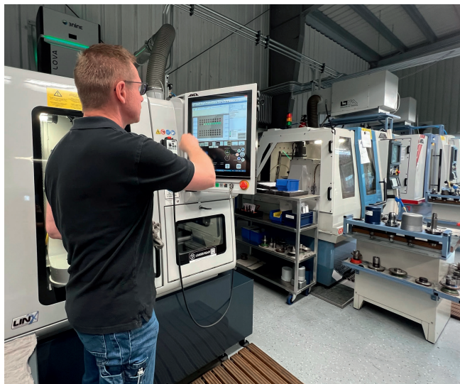
2 Jörg Scheidecker, Leiter Technik bei der Schnebelt Präzision, bedient die 'Robomate'-Software an der neuen CNC-5-Achs-Werkzeugschleifmaschine 'FX5' © Anca
